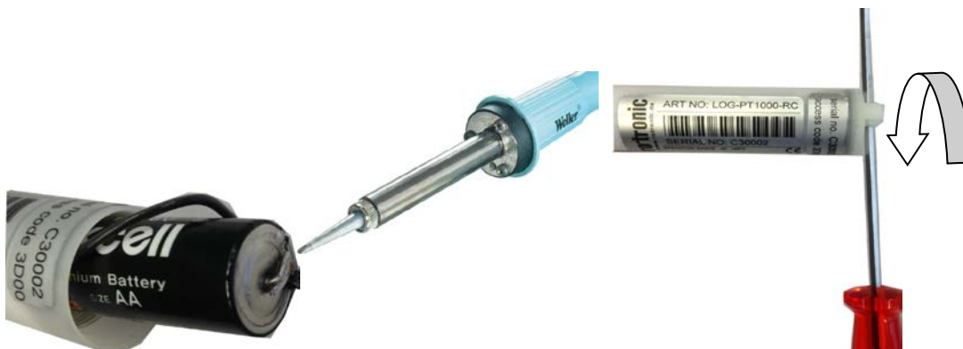
Abbildung 15: Anlöten der Lötanschlüsse und anschliessendes Verschrauben des Deckels.
