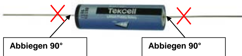
Abbildung 14: Kürzen und Abbiegen der Anschlüsse
