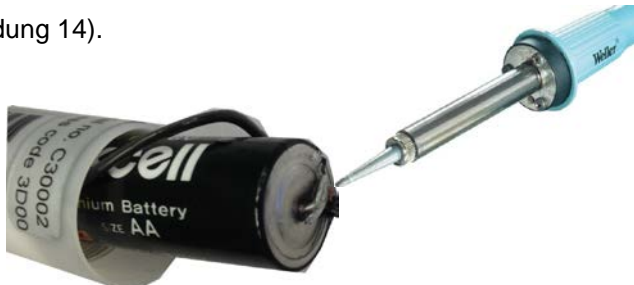
Abbildung 13: Ablöten der Batterie
