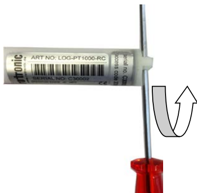
Abbildung 11: Lösen der Abdeckung mittels Schraubenzieher
