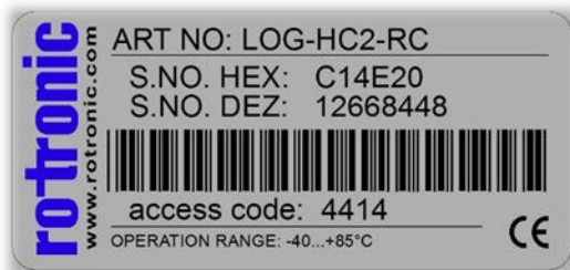
Abbildung 10: Etikette mit Zugriffs-Code (4414) zum Sperren/Freigeben des Loggers.
