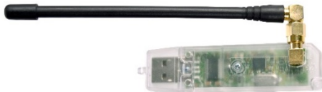
Abbildung 7: USB-Dongle für 433.92 MHz oder 915 MHz, kann bis zu 100 Endgeräte verwalten.
