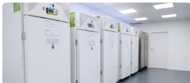
Lo stoccaggio in condizioni di stabilità prevede il ricorso a frigoriferi e freezer a svariate temperature.
