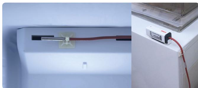
Per il monitoraggio dei frigoriferi isolati, si inserisce nel vano frigorifero una sonda a cavo collegata con il data logger wireless.
