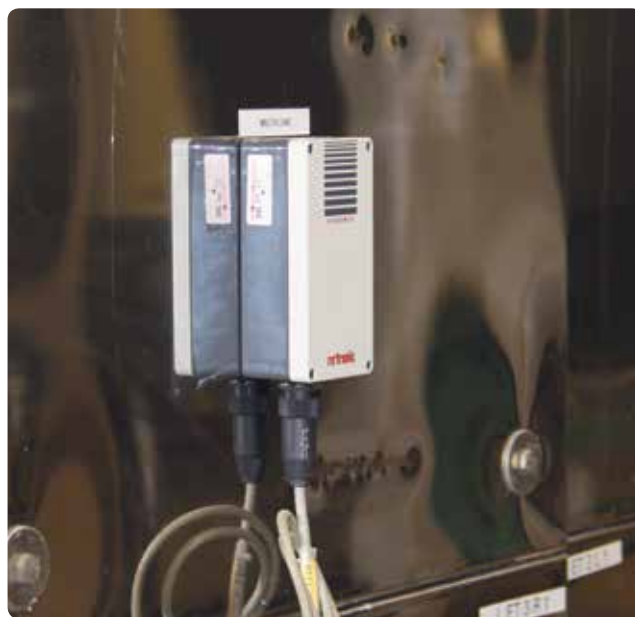
Sensore Rotronic I200, affidabilmente operativo da oltre 15 anni.
