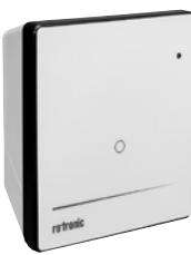
Tous nos remerciements pour l'achat du gateway RMS. Cet appareil transmet en continu, par Ethernet, les données du logger radio au logiciel RMS. Ce mode d'emploi abrégé décrit les fonctions essentielles de cet instrument.
