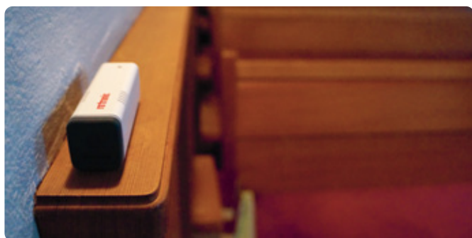
Mini logger radio RMS pour la saisie des données de température.
