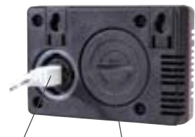
Mini connessione USB Vano batteria (impostazioni e download dati)
