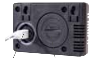
USB-Mini Anschluss (Einstellungen und Datendownload) Batteriefach
