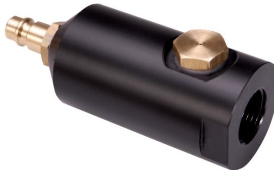
Abbildung 9: POM-Messkammer LDP-FCPB1 mit Druckluftanschluss (links), Fühlereinschraubgewinde (rechts) und Fixventil (oben).
