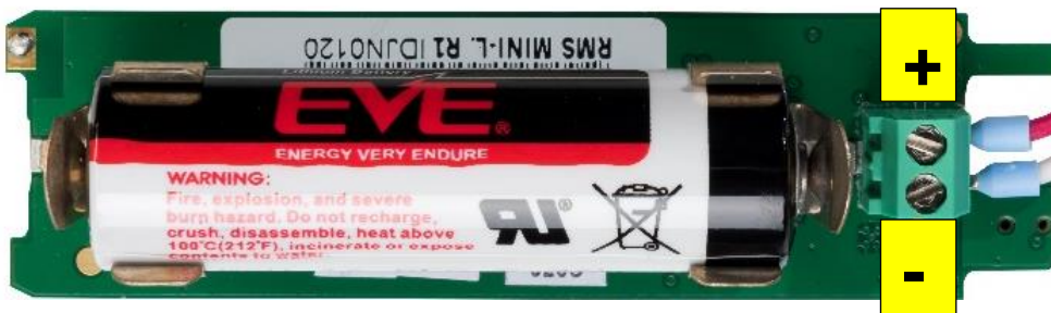
Abbildung 4: Minus Pol immer Richtung Taster/Pairungsknopf
