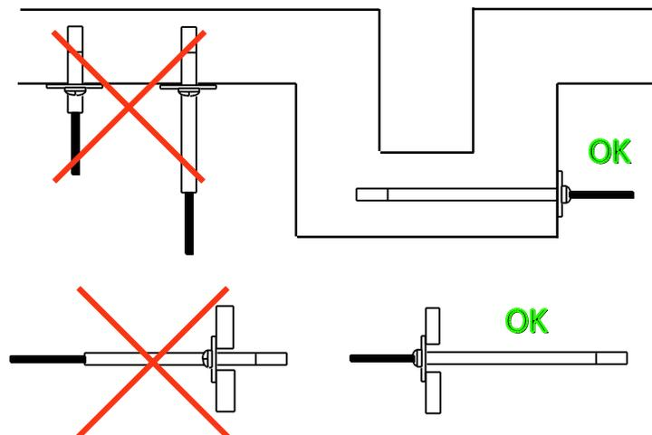
Beachten Sie, dass bei der Installation sich kein Kondenswasser am oder im Fühler ansammeln kann und einen Kurzschluss an den Sensoranschlüssen verursacht. Der Fühler soll bei der Installation mit der Sensorik nach unten montiert werden. So kann die Abwärme der Elektronik nach oben entweichen. Falls nicht möglich, ist auch eine horizontale Montage geeignet.
