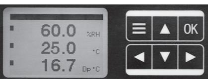
Remarque : l'accès non autorisé au menu peut être empêché en bloquant le réglage « Display Menu » (réglage avec le logiciel HW4).
